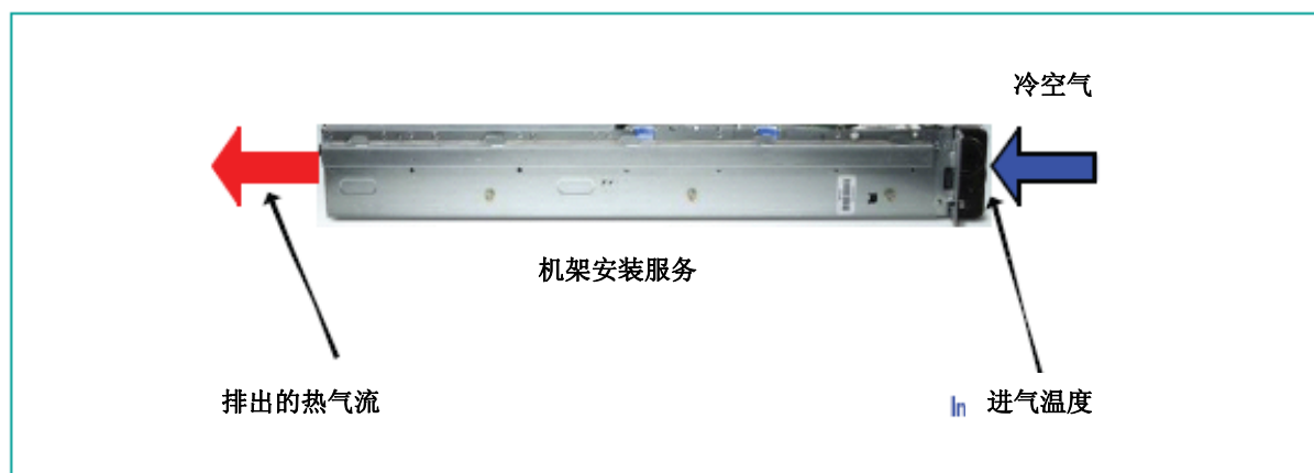
图 3.1 机架安装服务器的进气温度
